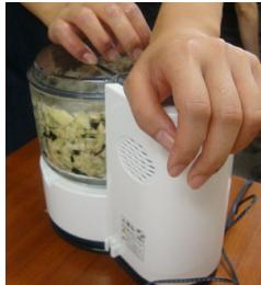
正しく数値を測定するために、フードプロセッサーで細かくします。写真はなす。下処理は想像より手間がかかり、測定よりも時間がかかったりします。
