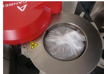
測定器を汚さないように試料の入った容器をビニールに入れてセットします
